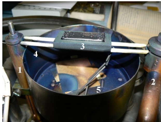
Рис. 1 – Графітовий випарник телуриду кадмію: 1, 2 – струмові вводи; 3 – графітовий тигель з кришкою; 4 – нагрівальні елементи; 5 – термопара
