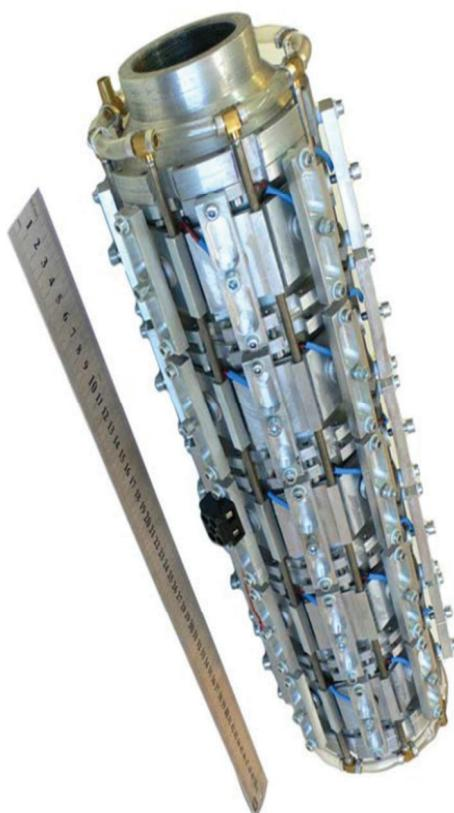
*Rис. 1. – Термоелектричний перетворювач*
