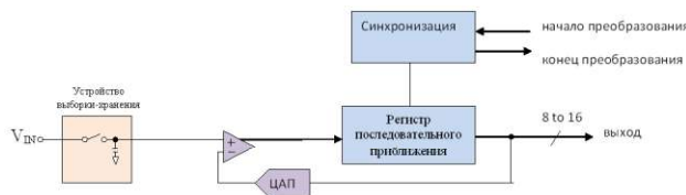
Рис. 2 – АЦП последовательного приближения
