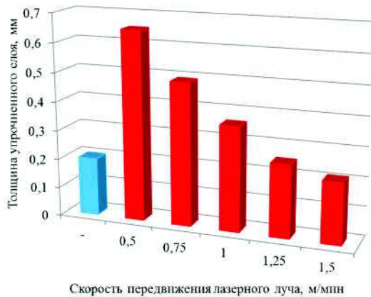
Рис. 1 – Влияние предварительной лазерной обработки стали на толщину упрочненного слоя в сравнении с толщиной азотированного слоя, полученного после азотирования без лазерной обработки (первый столбец голубого цвета)
