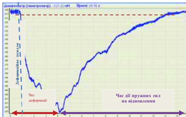
Рис. 3 – Деформаційна діаграма осьового розтягу зразків: повздожній зріз м'язів
