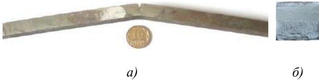
Рис. 1 – Загальний вигляд зразка (а) та площі деформованої поверхні зразка (б) після експерименту з дослідження умов спонтанного руйнування тривало експлуатованої бурильної труби
