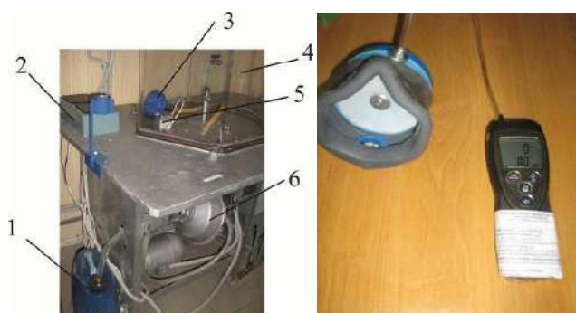
Рис. 7 – Установка для моделювання впливу вологості повітря на фільтри:
