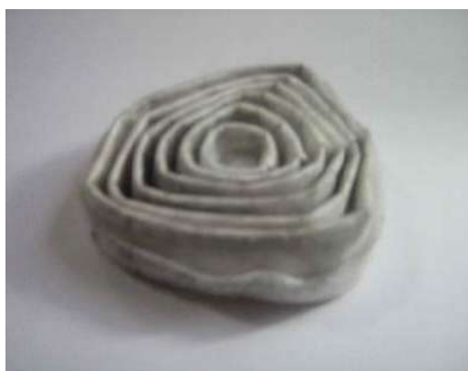
Рис. 2 – Вигляд запиленого фільтра
