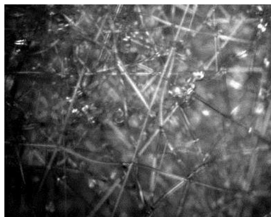
Рис. 8. – Вигляд структури елєфлену у 300-кратному збільшенні після дослідження
