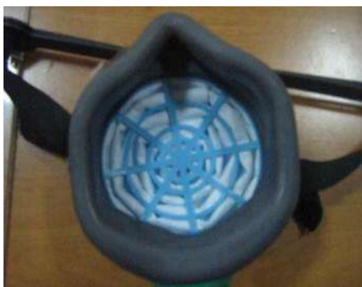
Рис. 4 – Вид півмаски де встановлювали клапан вдихання
