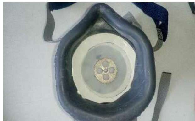
Рис. 5 – Вид зворотньої сторони півмаски з установленим клапаном
