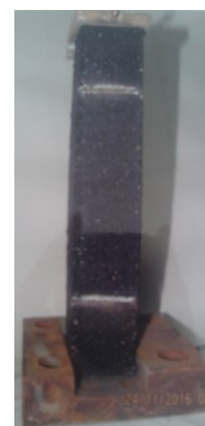
Рис. 2 – Зовнішній вигляд зразка для визначення модулю пружності із пропилами
