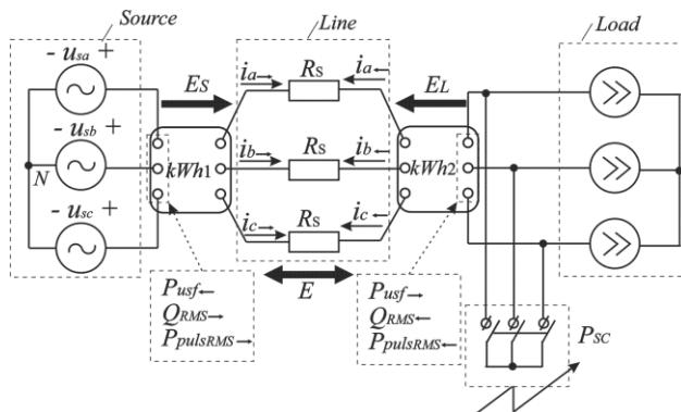
Рис. 1 – Эквивалентная схема трехфазной трехпроводной СЭ
