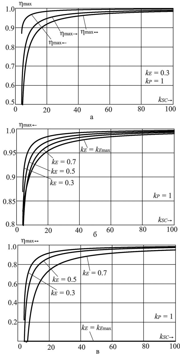
Рис. 2 – Залежності максимально можливого КПД від параметра  $k_{SC\rightarrow}$  для СЭ: а – при прямому потоці; б – при оберненому потоці; в – при двунаправленному потоці
