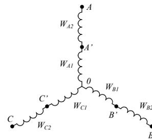
Рис. 9 – Схема соединения обмоток понижающего автотрансформатора
