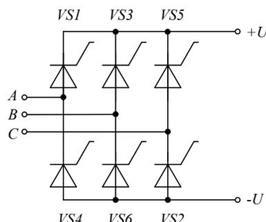
Рис. 2 – Схема управляемого выпрямителя  $B1$  и  $B2$
