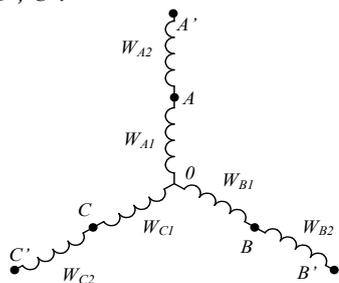
Рис. 5 – Схема соединения обмоток повышающего согласующего автотрансформатора
