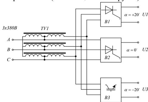
Рис. 4 – Схема 18-пульсного выпрямителя с повышающим согласующим трансформатором
