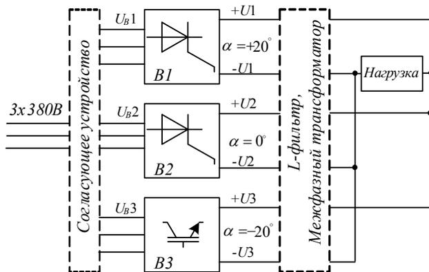
Рис. 1 – Схема выпрямителя с электронным сдвигом фаз
