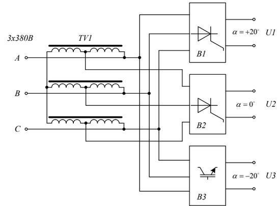
Рис. 8 – Схема 18-пульсного выпрямителя с понижающим согласующим трансформатором
