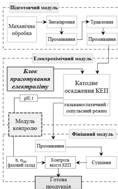
Рис. 2 – Узагальнена технологічна схема осадження КЕП
