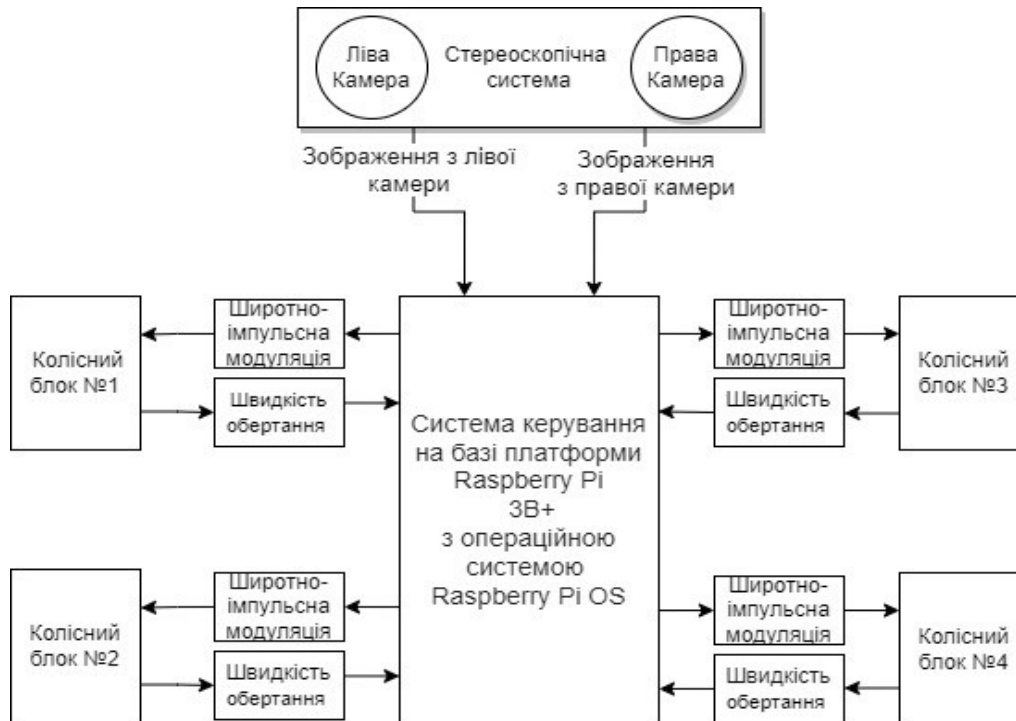
Рис. 3 – Структурна схема роботизованої платформи
