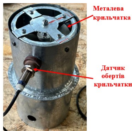
Рис. 5 – Фото верхньої частини труби з розміщеною в ній крильчаткою та датчиком обертів
