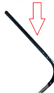
Рис. 4 – Фото нагару утвореного на трубці Піто в процесі проведення експерименту
