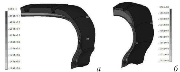
Рис. 18 – Розподіл еквівалентних напружень (а –автомобільної шини, б–велосипедної шини)
