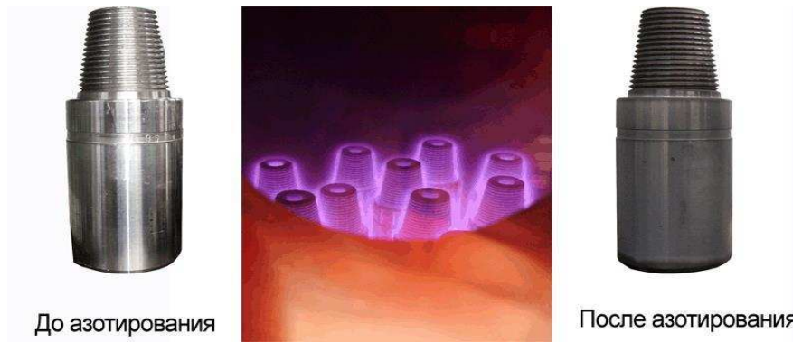
Рис. 10 – Деталі до і після іонно-плазмового азотування
