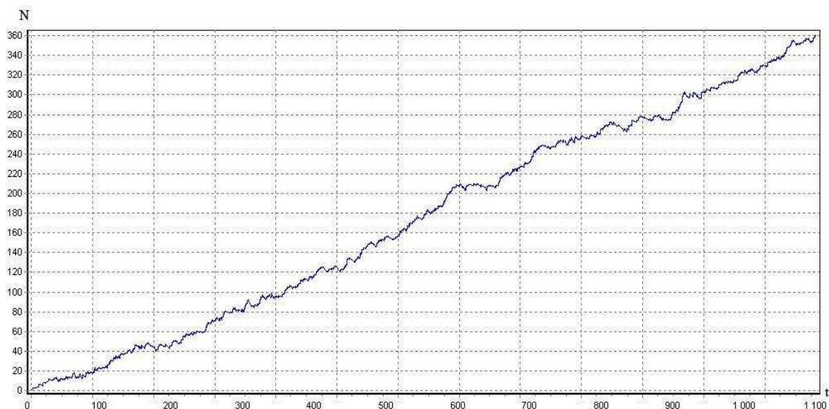
Рис. 2 – Залежність кількості вимог у системі від часу (для системи M/M/10/0/L/M при високому навантаженні)
