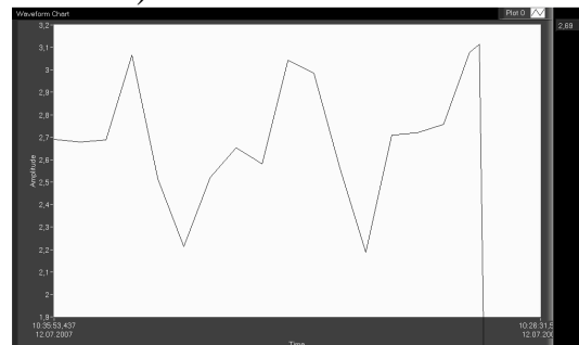
Рис. 12. График изменения напряжения на выходе насоса, в канале измерения скорости вращения насоса, от времени с подключением к каналу конденсатора емкостью 100 мкФ, при постоянной скорости вращения насоса на входе
