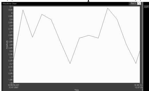
Рис. 11. График изменения напряжения на выходе насоса, в канале измерения скорости вращения насоса, от времени с подключением к каналу конденсатора емкостью 470 мкФ, при постоянной скорости вращения насоса на входе
