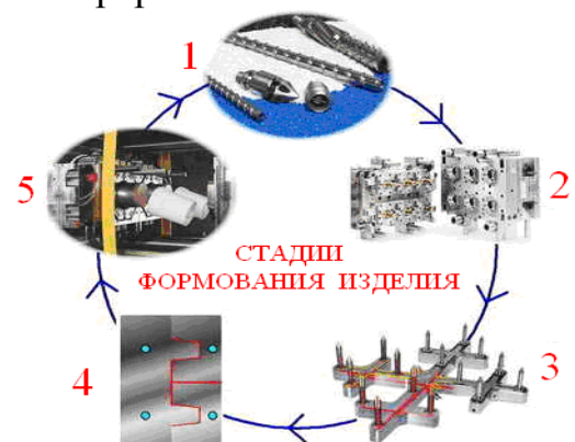
Рис. 1. Стадии формования изделий методом литья под давлением
