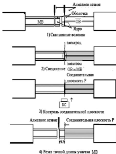
Рис. 3 Процесс производства каскадного волокна
