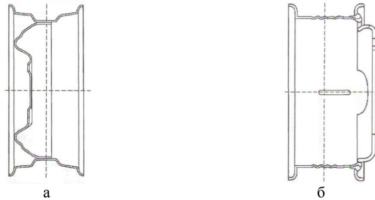
Рис. 1 – Поперечный разрез колеса, обод которого изготовлен методом радиального профилирования: а – легкового и б – грузового автомобилей
