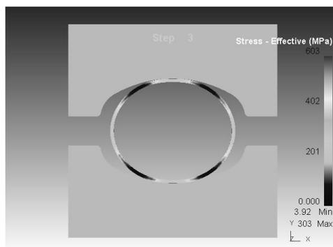
Рис. 3 – Модель схемы формообразования для промежуточного шага нагружения
