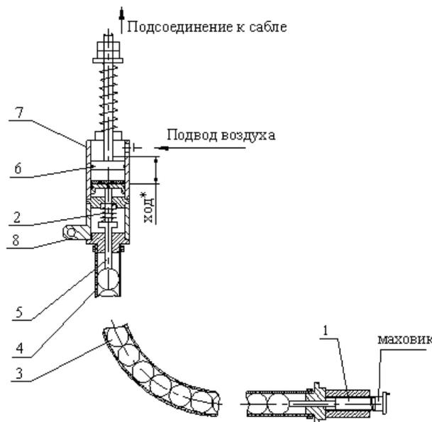
Рис. 3 – Схема новой системы управления штамповочным молотом
