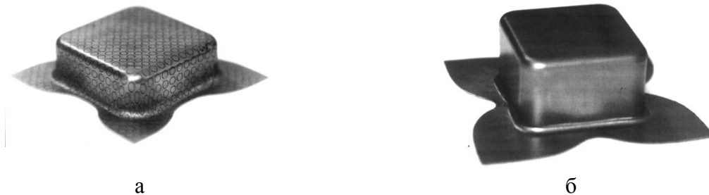
Рис. 3 – Утворення нерівного фланця при витягуванні прямокутних коробчастих деталей: а – [5], б – [1]
