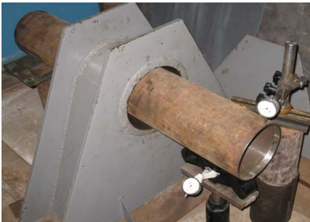
Рис. 2 – Загальний вигляд лабораторного стенду для побудови тарувальної характеристики
