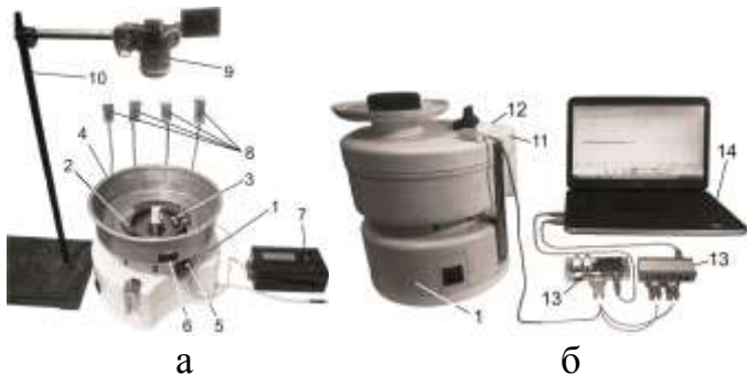
Рис. 2 - Фотографии конфигураций стенда СВ с АБ: а – для доводки АБ и исследования относительного движения шаров в стробоскопическом свете; б – для исследования эффективности работы АБ по виброускорениям
