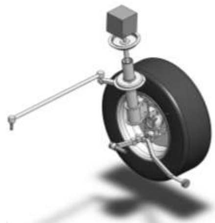
Рис. 1 – Твердотельная модель подвески (передняя левая стойка)
