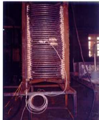
Рис. 2 – Общий вид нагревательного элемента термовакуумной установки
