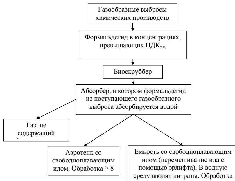
Рис. 1. Биотехнологические методы снижения концентрации формальдегида в газообразных выбросах химических производств
