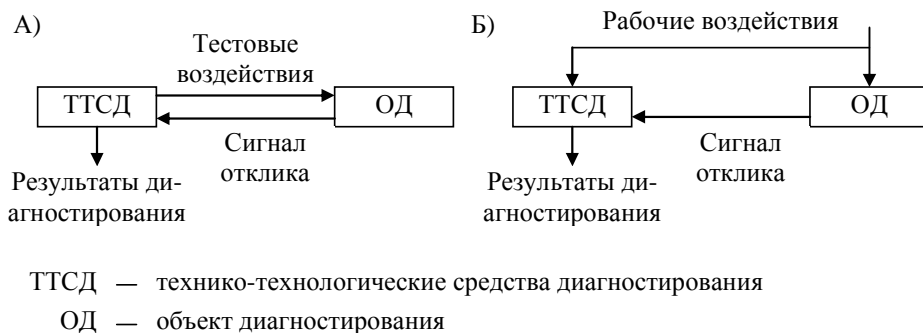
Рис. 2. Типовые общие схемы систем диагностирования на транспорте: А) тестовое диагностирование; Б) функциональное диагностирование (на основе [8, с. 26; 9, с. 198])
