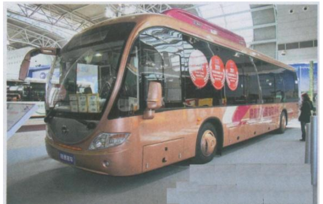
Рис.2. Електробус СКЗ612 має подвійний порт для прискореної підзарядки
