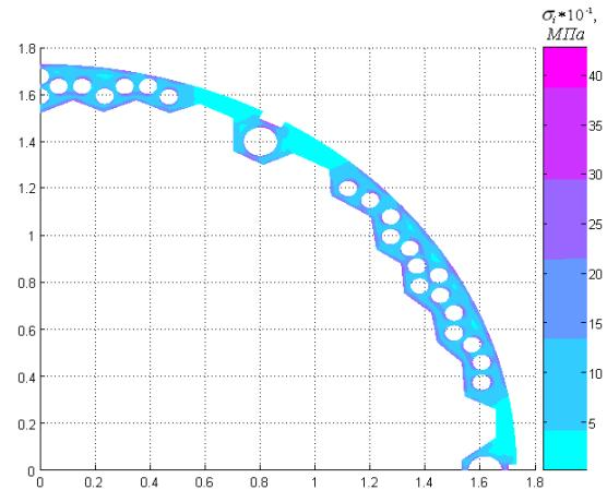
Рис. 2. Распределение интенсивности температурных напряжений
