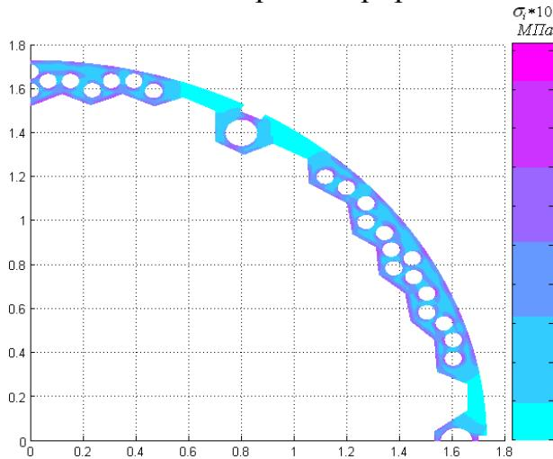
Рис. 3. Распределение интенсивности напряжений по сечению выгородки после 17 лет эксплуатации без учета циклического изменения температур
