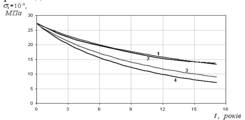
Рис. 5. Изменение интенсивности напряжений в выгородке
