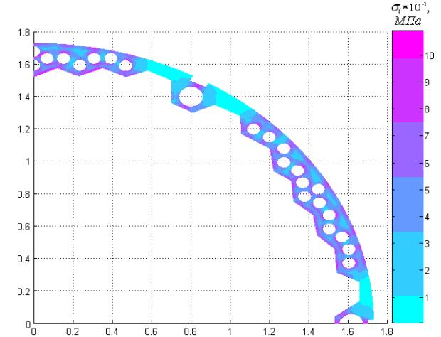
Рис. 4. Распределение интенсивности напряжений по сечению выгородки после 17 лет эксплуатации с учетом циклического изменения температур при 7000 часов эффективной работы реактора в год
