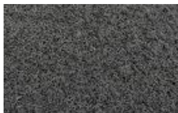
Рис.3. Аморфный осадок, выделяющийся на стенках реактора при соотношении \text{SiCl}_4:\text{C}_7\text{H}_8=3,5 (x 750)
