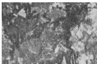
Рис.5. Морфология конденсата при соотношении \text{SiCl}_4:\text{C}_7\text{H}_8=7,4 (x750)
