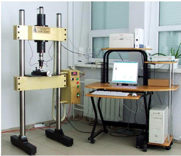
Рис. 2 – Універсальна випробувальна машина UTM – 20 НТ для інденування металів кулькою із твердого сплаву
