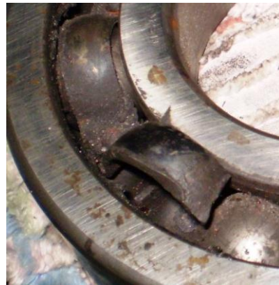
Рис. 2 Цвета побежалости на сепараторе разрушенного подшипника
