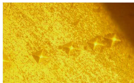
Рис.5 - Структура стали 20X13 после ермостабилизации. x 500
