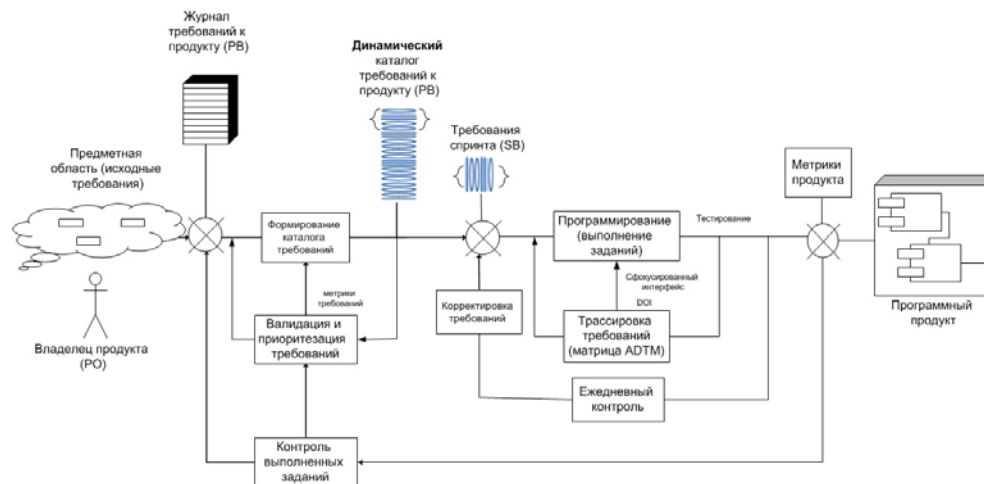
Рис. 6 – Схема автоматизированного управления Scrum-процессом разработки ПО
