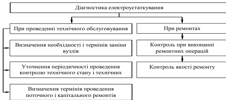
Рис. 2 – Область застосування технічних засобів діагностики при використанні ОФС
