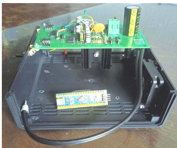
Рис. 4 – Зовнішній вигляд прототипу з налагоджувальною платою STM32F103C8T6 та встановленим інвертором «А»
