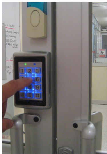
Рис. 3 – Електронний замок із PIN-клавіатурою як засіб двофакторного контролю фізичного доступу до захищеного приміщення.
