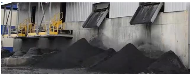
Рис. 5 – Вилучення вугілля із шламонакопичувачів вуглезбагачення: а – забір згущеного шламу та його транспортування на модуль; б – класифікований продукт після механічного зневоднення
