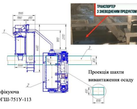
Рис. 3 – Модульна установка зневоднення рідких відходів вуглезабагачення
