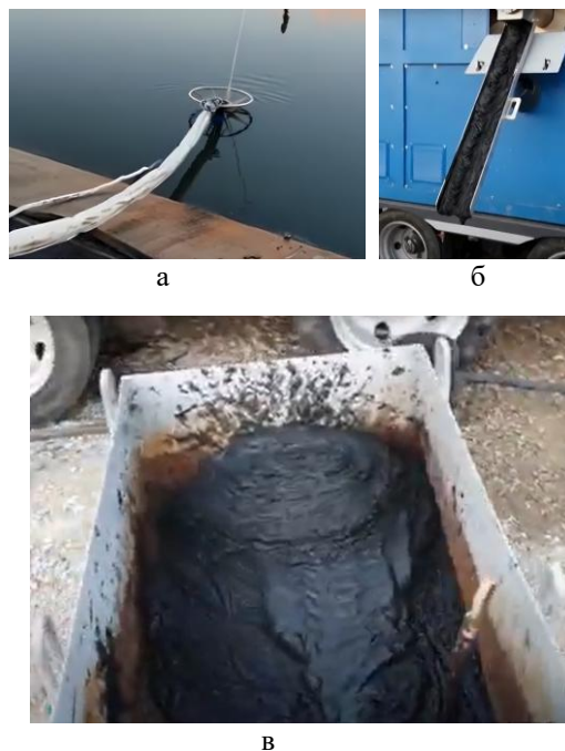
Рис. 2 – Пересувні модульні установки для вилучення та первинної переробки донних відкладень шламонакопичувачей: а – занурений всмоктувальний пристрій для виїмки пульпи з донних відкладень; б – вивантаження частково зневодненого осаду через похилий конвеєр після барабанного сита; в – зневоднений осад після механічного розділення в мобільному комплексі
