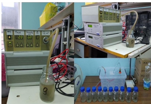
Рис. 1 – Лабораторний стенд для проведення експериментальних досліджень процесу знезараження води озонуванням
